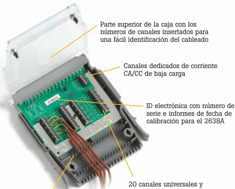
Parte superior de la caja con los números de canales insertados para una fácil identificación del cableado
