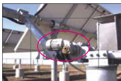
Motor con un calentamiento excesivo debido a un fallo de aislamiento
