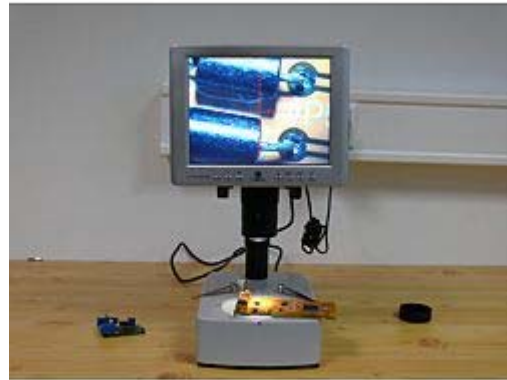
Aquí ve el microscopio para taller investigando una placa
