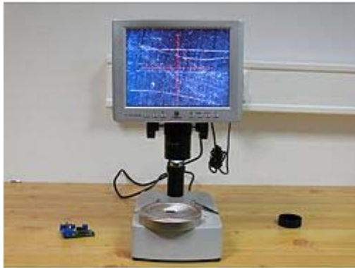
Aquí ve el microscopio para taller investigando una superficie metálica.
