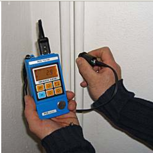
Medidor de espesores de material midiendo una tubería
