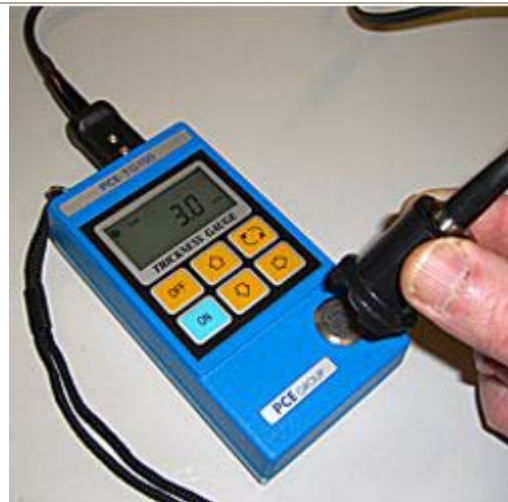
Recalibración del medidor de espesores de material
