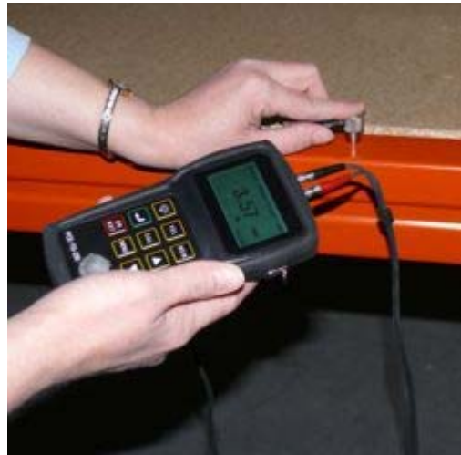
Aquí se ve el medidor de espesores por ultrasonido TG 250 en una aplicación.
