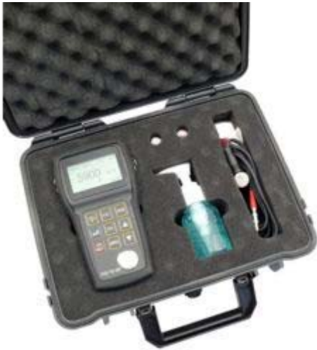
Aquí se observa el medidor de espesores por ultrasonido TG 250 en el maletín.
