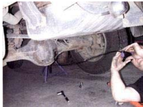
Endoscopio en la revisión de engranajes
