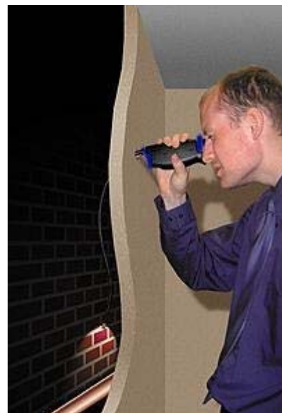
Endoscopio analizando una oquedad
