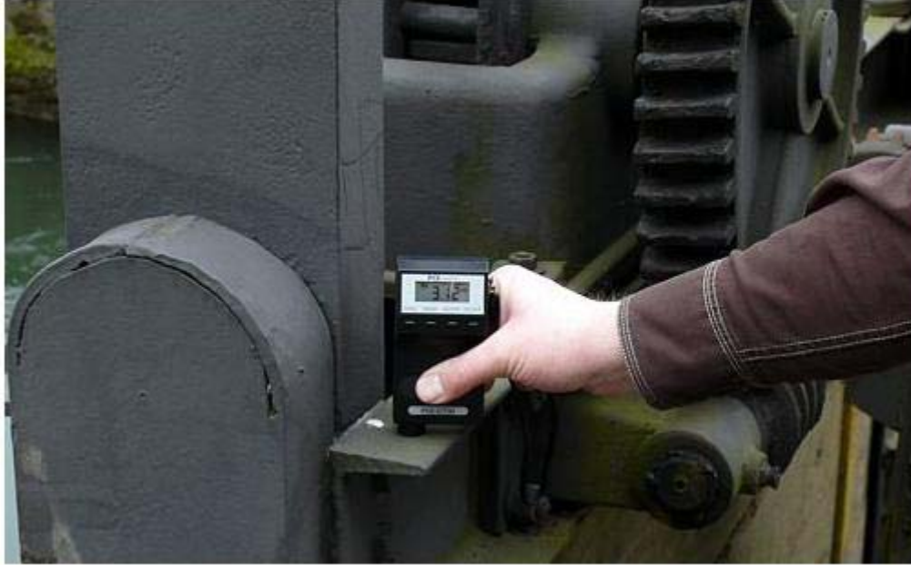
Aquí ve el medidor de espesor CT haciendo una medición.
