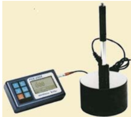
Durómetro 2000 (tipo de impacto D) con sensor externo sobre bloque de prueba
