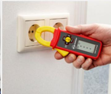
La función de tensión sin contacto (NCV) comprueba la presencia de tensión.
